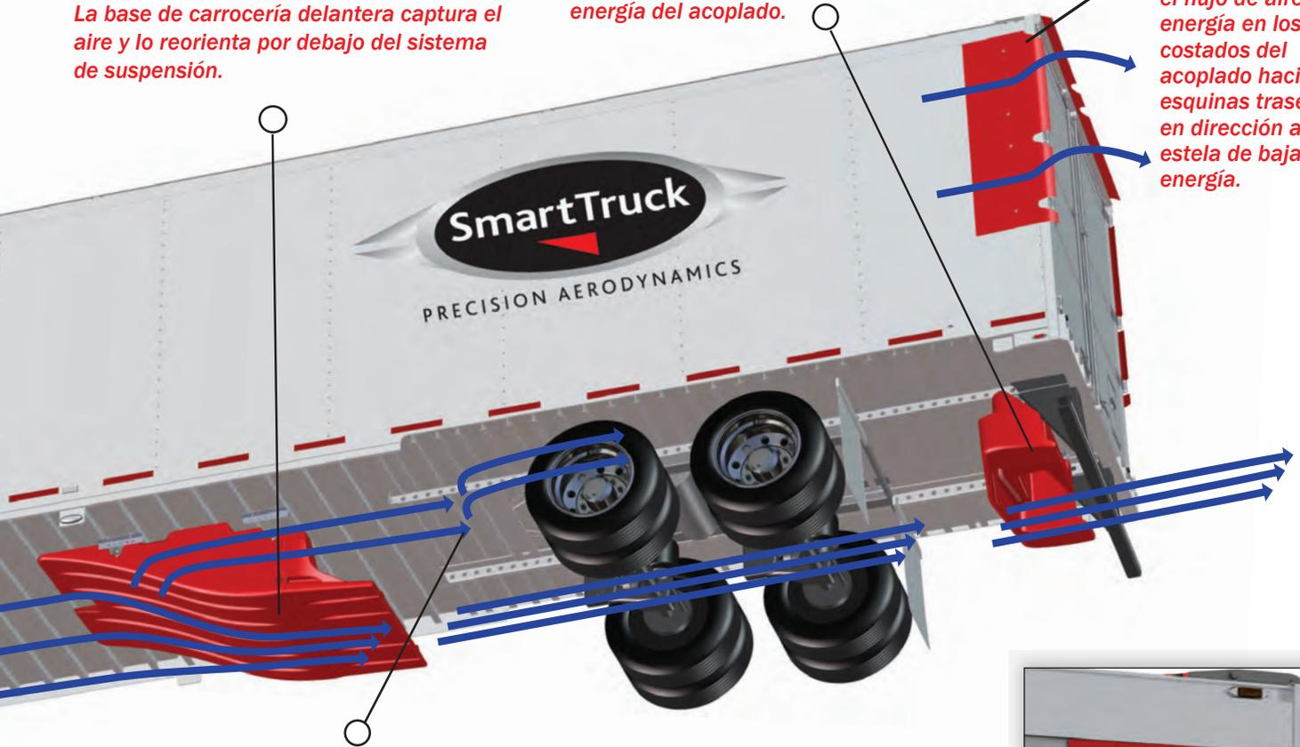
El flujo de aire creciente que proviene del costado de la base de carrocería delantera contribuye a la refrigeración de las ruedas y los frenos.
