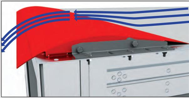
La protección aerodinámica para lluvia comprime y reorienta el flujo de aire de alta energía que se desplaza sobre el techo del acoplado hacia la esquina trasera y hacia abajo en dirección a la estela del tráiler de baja energía.
